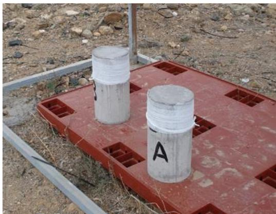
Figura 4. Probetas cilíndricas con la bufanda
