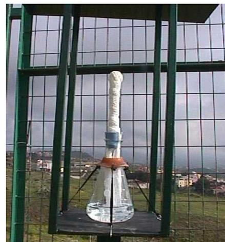
Figura 3. Dispositivo de vela húmeda para la captación de cloruros del aerosol marino
