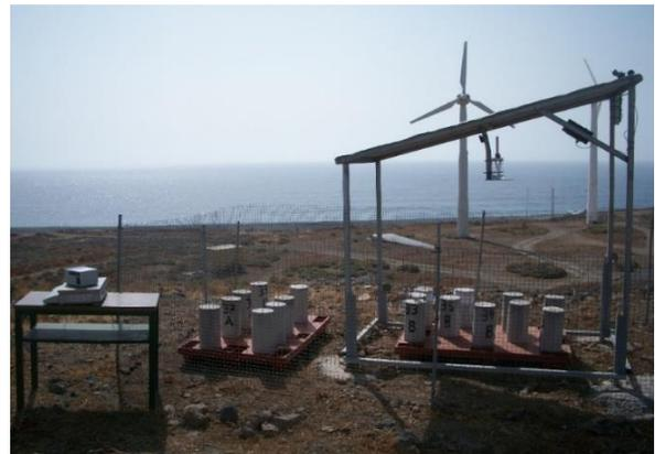
Figura 2. Probetas cilíndricas en estación de ensayo
