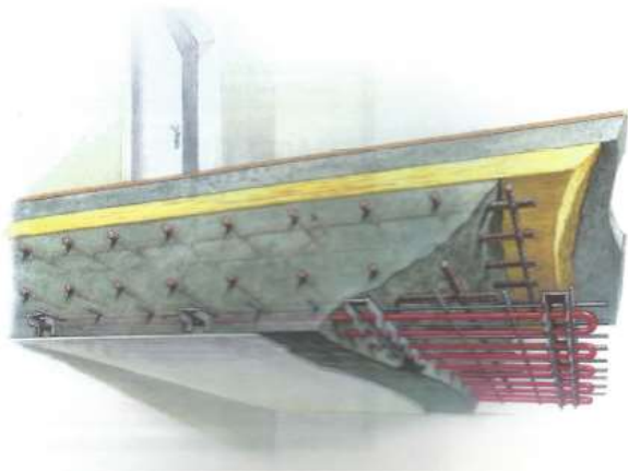
Figura 2. Configuración de forjado activado térmicamente [3].
