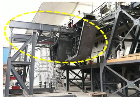
Figura 24. Encofrado interior retráctil.
