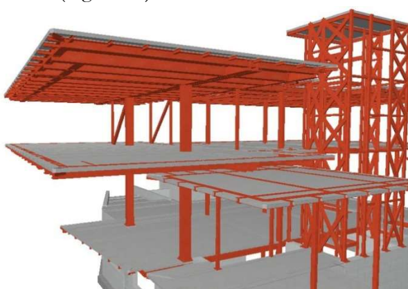
Figura 17. Modelo de cálculo de la estructura de la vivienda.
