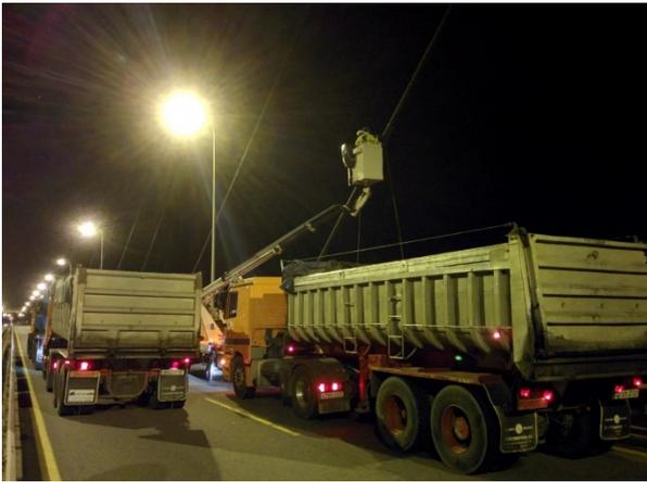
Figura 4. Ensayo de calibración, instante de auscultación dinámica de tirante cargado.
