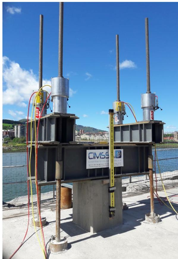
**Figura 10. Prueba de carga de micropilote multibarra a compresión.**
