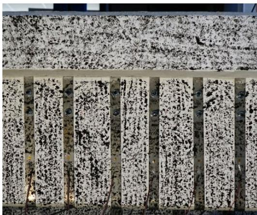
Figura 2. Refuerzo en U colocado en el alma de las vigas de sección en T, anclado mediante dos anclajes mecánicos
