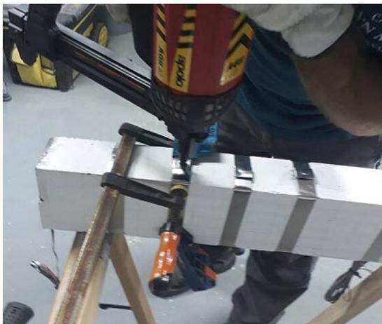
Figura 1. Colocación del refuerzo en las vigas rectangulares
