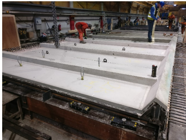
Figura 9. Panel prefabricado de alma inclinada
