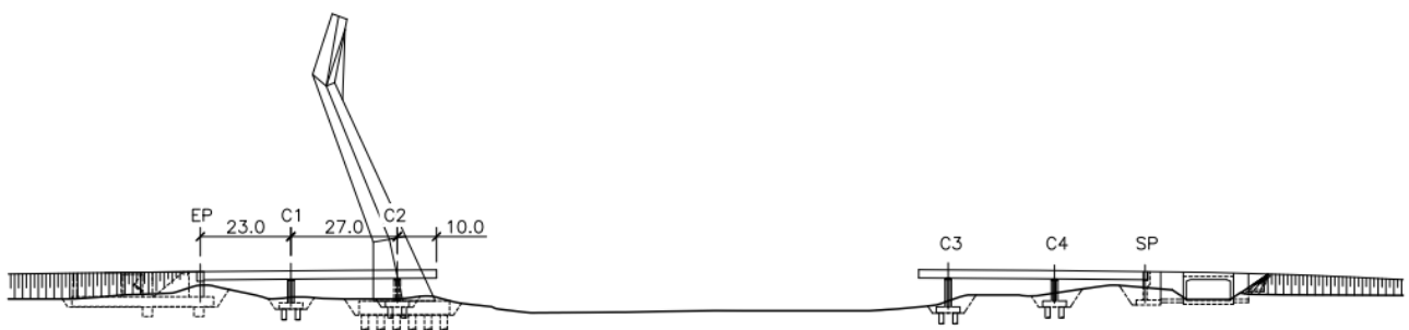
Figura 5. Construcción de vanos menores en tierra sobre cimbra cuajada.
