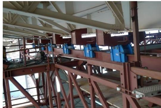
Figura 20. Sistema de rodadura del carro inferior.
