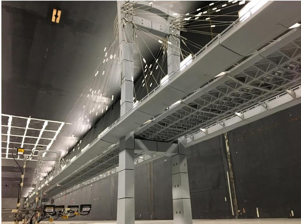
Figura 6. Modelo aeroelástico integral. Vista inferior.
