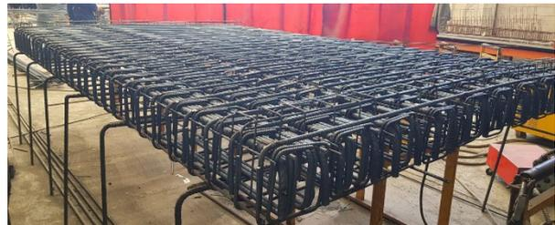
Figura 8. Armado de losas prefabricadas
