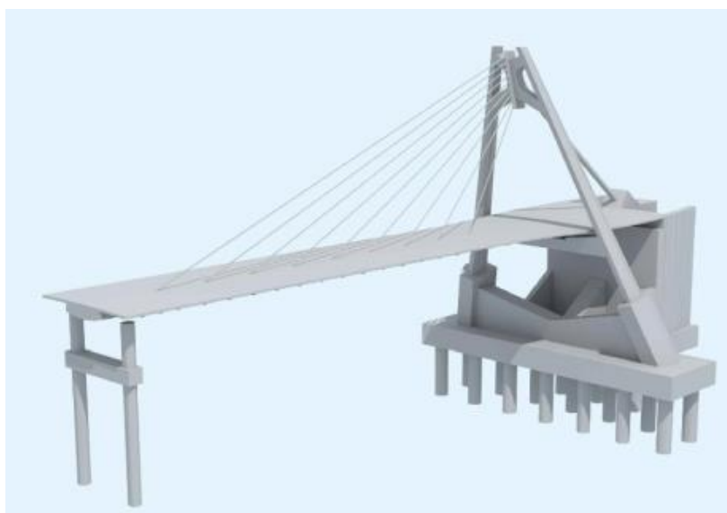
Figura 6. Visualización tridimensional del Viaducto Arroyo Paneque
