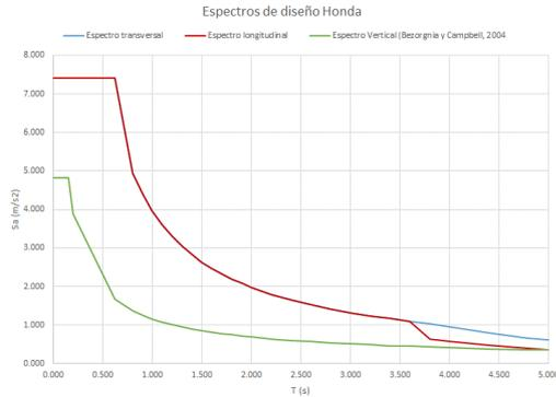
Figura 18. Espectros de diseño Puesto de Honda [6]
