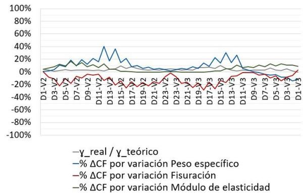
**Figura 15. Variación contraflechas por cambios en peso específico, módulo de elasticidad y fisuración**
