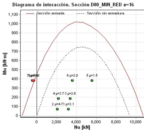
Figura 10. Tabla cumplimiento columnas inclinadas
