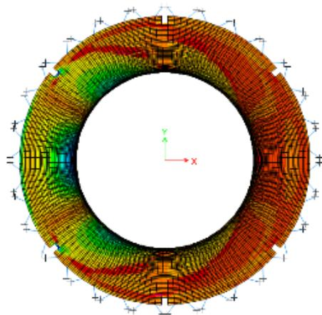
Figura 9. Tensiones durante la acción de viento
