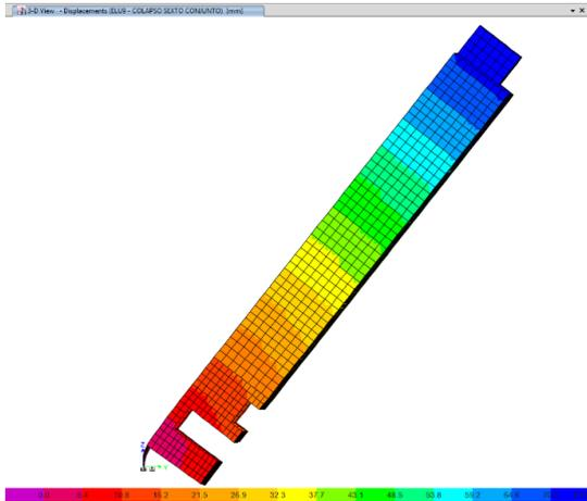
Figura 13. Giro en caída de Torre Gasificación
