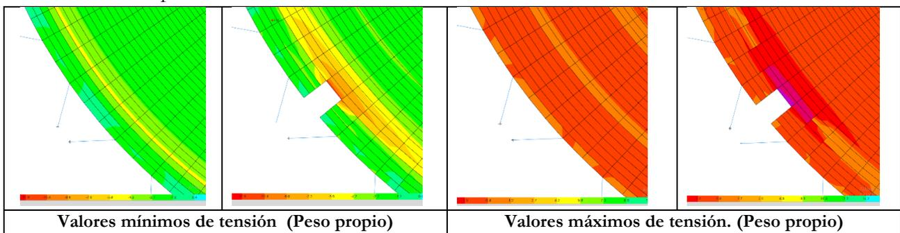
Para la Torre de Gasificación, se plantea la ejecución de ventanas en las tres primeras plantas de la fachada noroeste, y ventanas en las fachadas suroeste y noroeste favoreciendo la eliminación de una cuña frontal que fuerce la caída del edificio en ese sentido, a través de la formación de una charnela que permita el giro del edificio generado en la fachada sureste.
