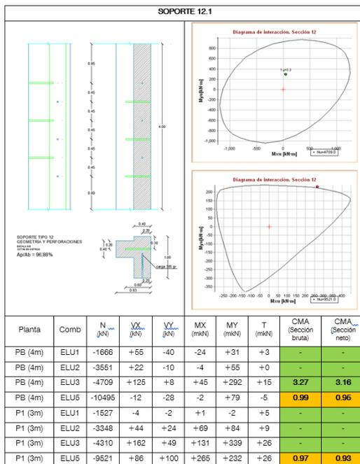
Figura 14. Análisis capacidad de columnas en base
