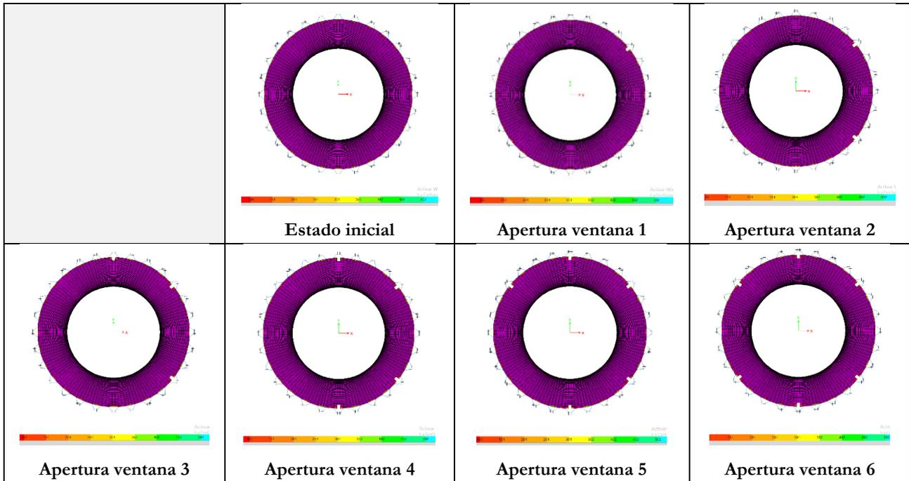
A través de este análisis de apertura de ventanas por etapas se examina la respuesta de la estructura y de las tensiones en su entorno debido a las irregularidades generadas en el funcionamiento por forma de esta estructura hiperbólica.
