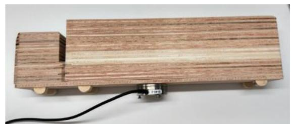
La razón de obtener registros de fuerzas y momentos en tiempo real es que de esta manera se pueden trasladar a la escala del prototipo sin más manipulaciones y así determinar las condiciones de equilibrio del vehículo. Para dar este paso se convierten la fuerza y el momento en coeficientes aerodinámicos función del tiempo.
