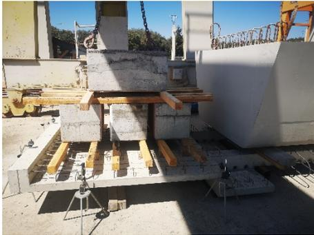
**Figura 20. Prueba de carga prelosa**
