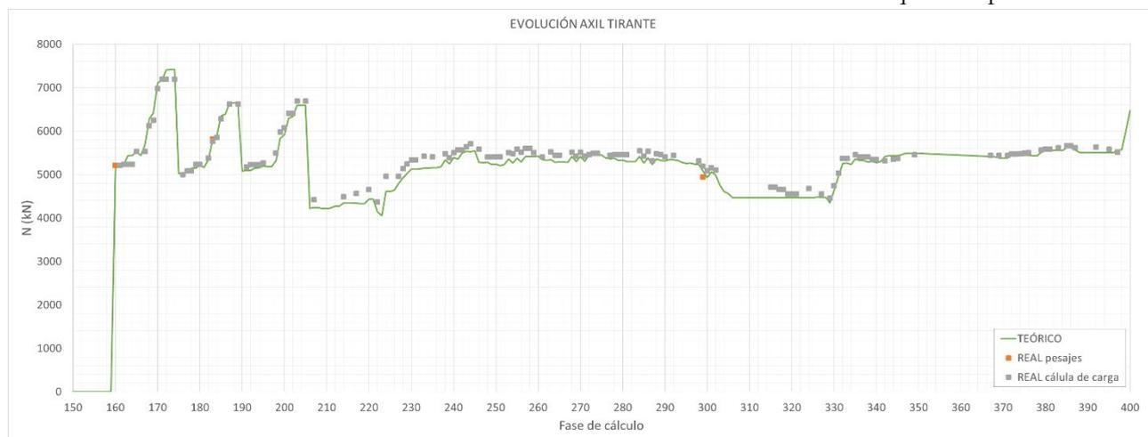
dovela: volumen de hormigón vertido, densidad del hormigón, peso de ferralla dispuesta y peso real de las deltas de anclaje. El modelo de seguimiento se actualizaba periódicamente para considerar exactamente el peso real de cada una de las dovelas.
