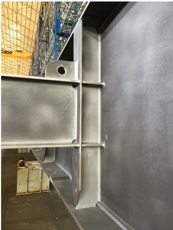
**Figura 8. Detalle de rigidizador transversal y marco en H, en taller.**
