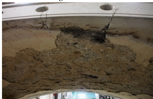
Figura 6. Dovela de hormigón reforzado con fibras de acero sometida a fuego
