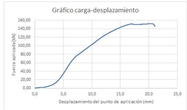
Ilustración 12: Gráfico Carga-Desplazamiento de ensayo de modelo escalado
