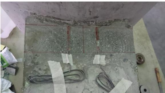
Ilustración 11: Galgas extensométricas en cara de compresión.
