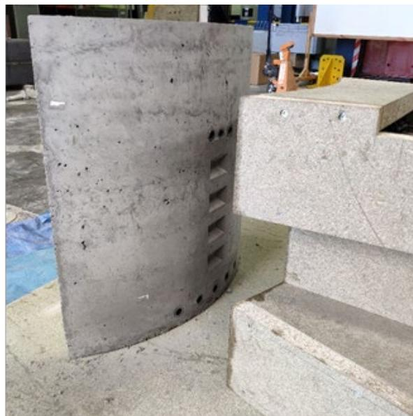
Ilustración 9: Encofrado conjugado de pétalo a cáliz fraguado.
