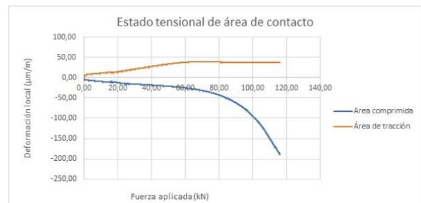
Ilustración 13: Gráfico del estado tensional de áreas de contacto
