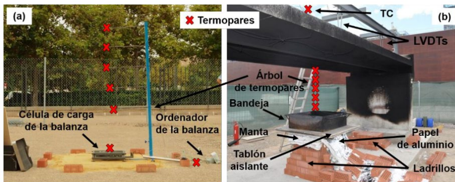
Figura 2. Elementos característicos del montaje del ensayo.
