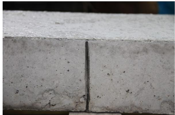
**Figura 2. Inductor de fisuras en la zona central.**
