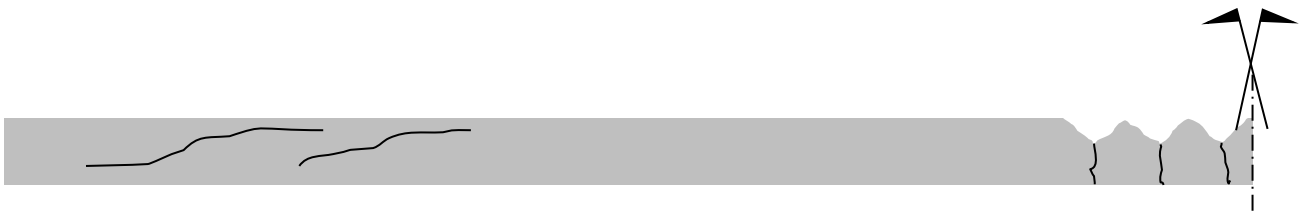
Figura 7. Forma de rotura de las correas deducida de su inspección.
