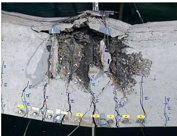
Figura 9. Formación de rótula en una sección agotada a flexión simple en el dominio 2 (cuantía habitual) [3].
