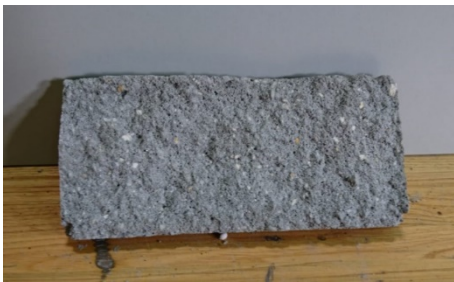
Figura 7: Probeta de hormigón con aireante
