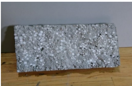
Figura 9: Probeta de hormigón con modulador y EPS
