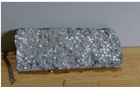
Figura 8: Probeta de hormigón con aireante y EPS
