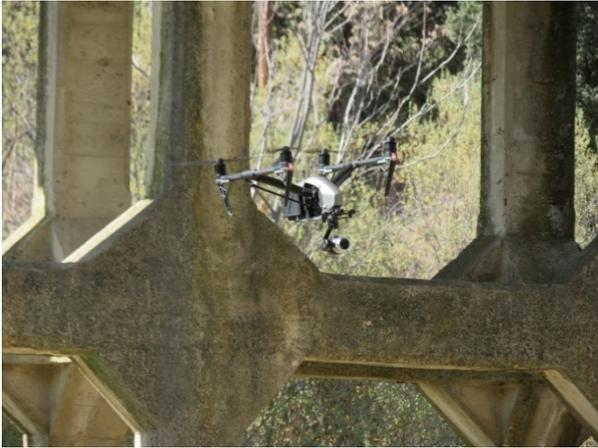
Figura 7. Dron con cámara Full-HD.
