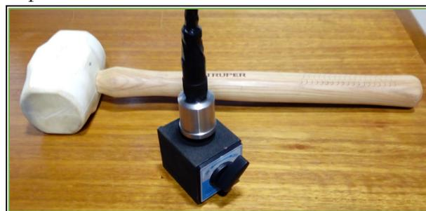
Figura 5. Acelerómetro KS48C con soporte magnético y martillo.
