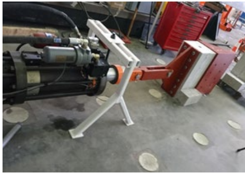
Figura 12: Probeta durante fisuración
