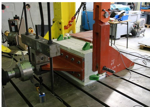
Figura 17: Montaje del ensayo de cortante
