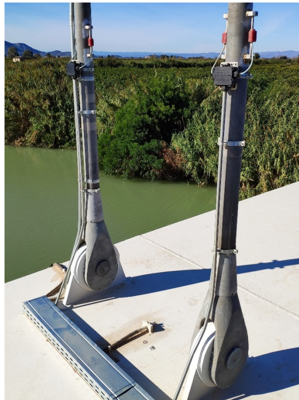
Figura 5. Extensómetro de cuerda vibrante (3)
