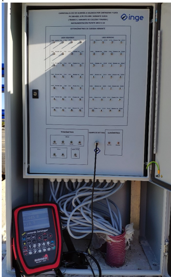
Figura 6. Central de lectura y equipo portátil de medida
