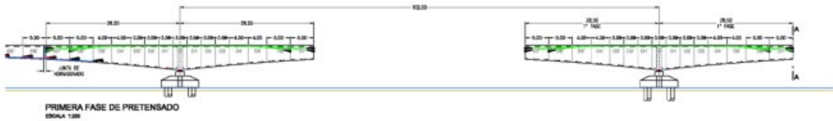
Figura 11. Secuencia de la ejecución del primer tramo sobre apoyos
