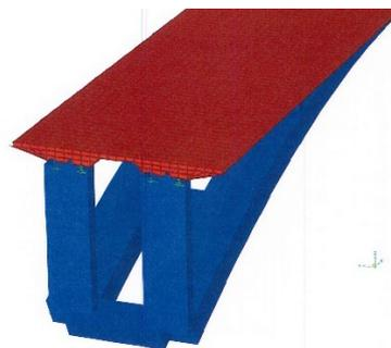
Figura 6. Sección Tablero Modelo 3D sólidos
