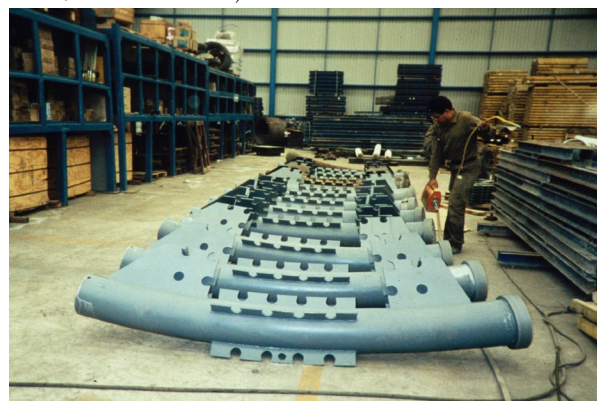
Figura 4. Tubo exterior unido a la torre del puente de Grijalva.
