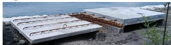
Figura 10. Ensayo de prelosa de voladizo
