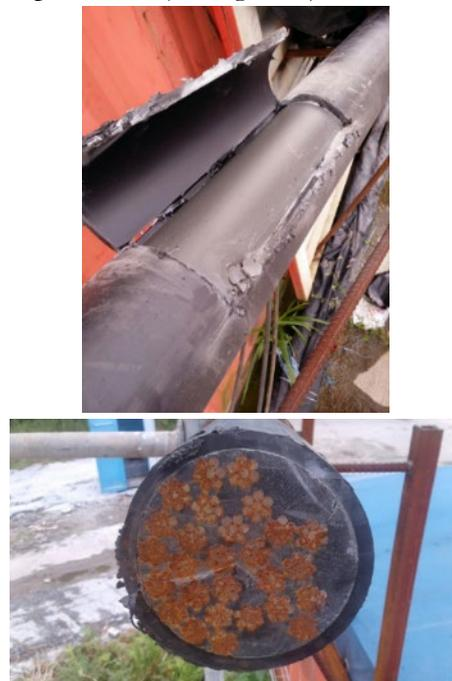
**Figura 7: Prueba a escala real del pretensado, verificación del relleno en punto alto.**
