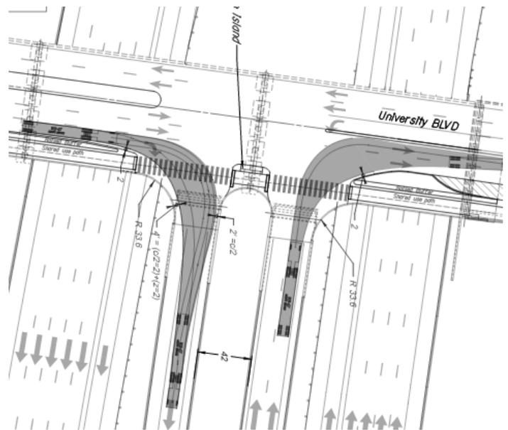
Figura 4. Envolverte de trayectorias (Auto turn).
