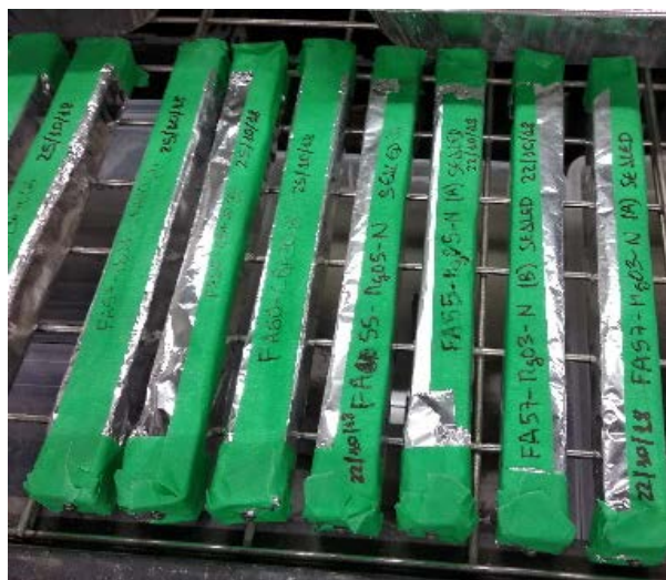
Figura 3: Probetas para medición de retracción autógena, selladas con papel de aluminio
