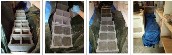
Figura 3. Proceso de llenado y curado de los bloques de hormigón.
