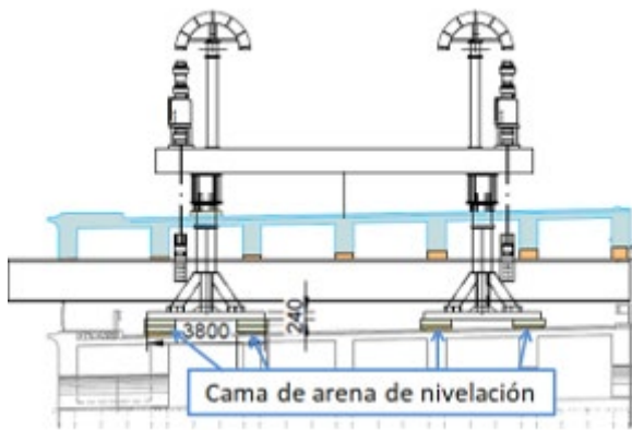
Figura 9. Camas de nivelación bajo patas de apoyo de sistema de izado.
