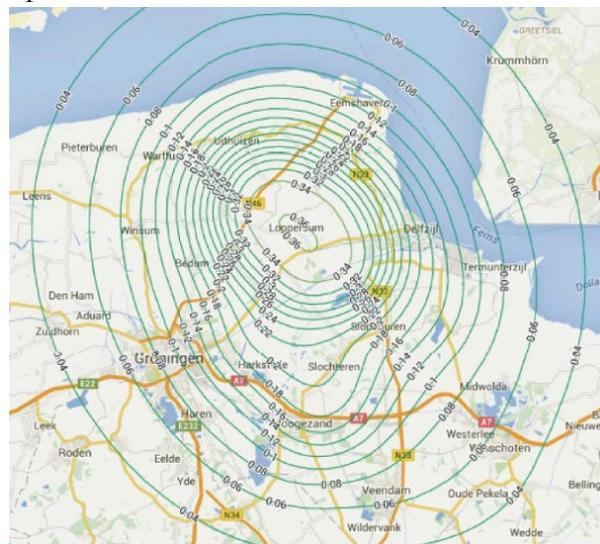
Figura 1. Mapa sísmico (PGA) correspondiente a la normativa NPR 9998:2015.
