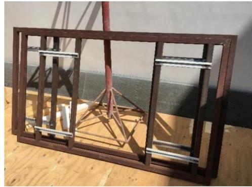
**Figura 22. Marco auxiliar para ajuste de anclajes**
