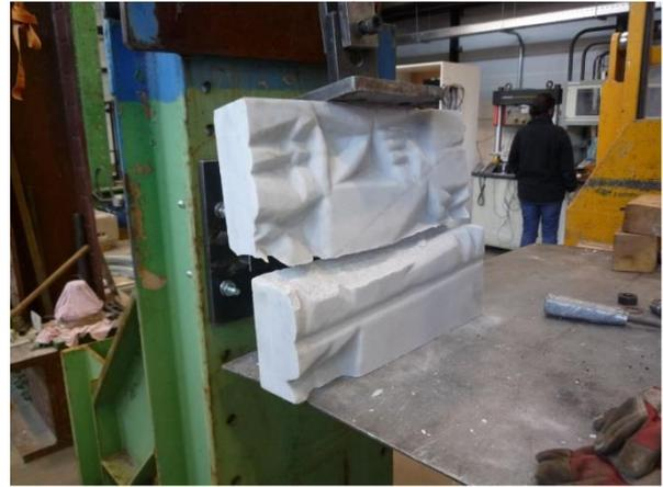
Figura 18. Modo de rotura bajo carga gravitatoria. Sección 2-2' [6]
