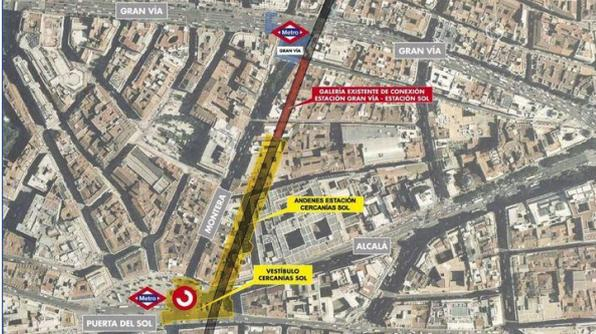
**Figura 5. Planta esquemática de la conexión con Cercanías**
