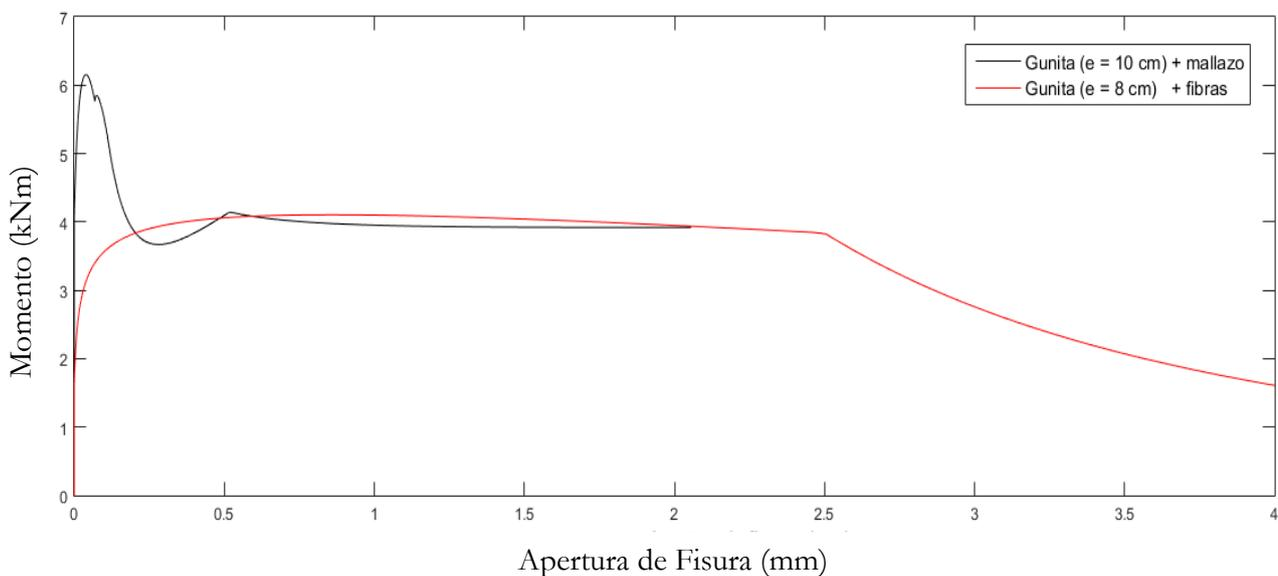
**Figura 5. Diagrama momento-apertura de fisura. Comparación entre la solución de proyecto y la solución propuesta con fibras**
