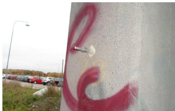
**Figura 18. Electrodo insertado.**
