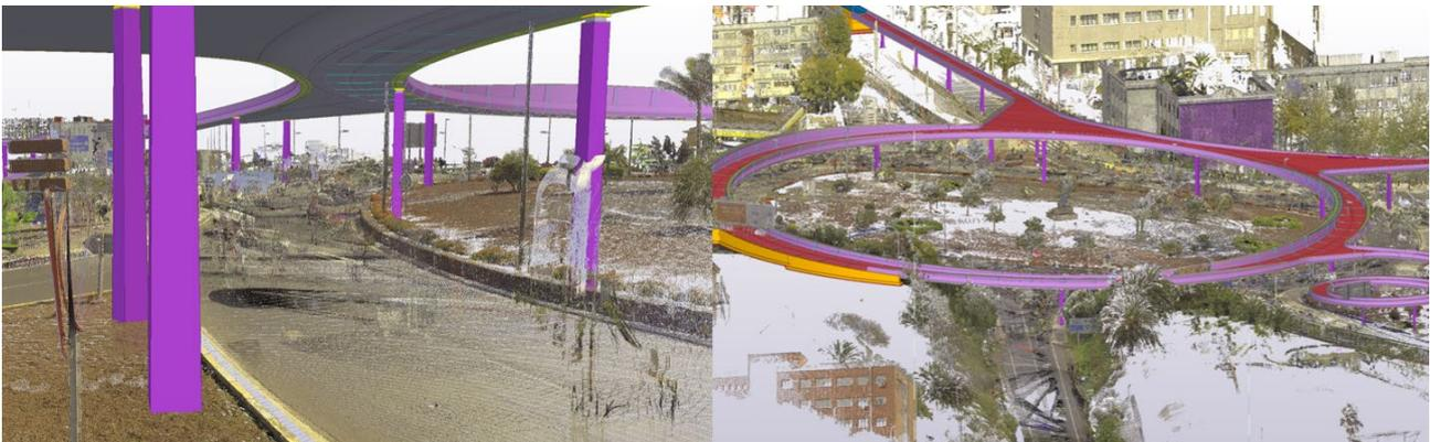
**Figura 7. Vistas de modelo virtual estructural con nube de puntos existente.**
