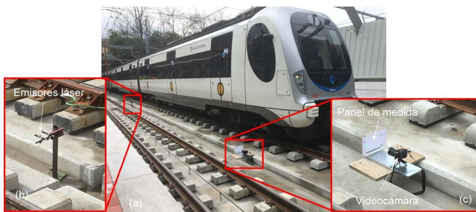
Figura 12. Descripción del ensayo en campo: (a) Vista general. (b). Referencia fija. (c) Referencia móvil.
