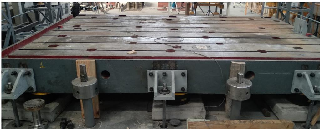
Figura 2. Mesa sísmica, junto con su utillaje principal.
