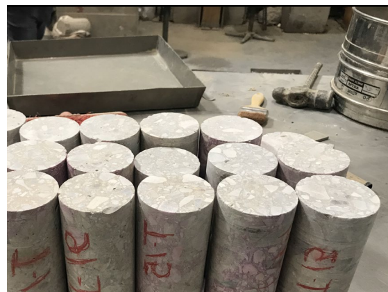
Figura 6. Conjunto de testigos de las pilas
