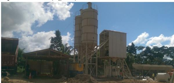
Figura 17. Planta de hormigones a pie de obra.
