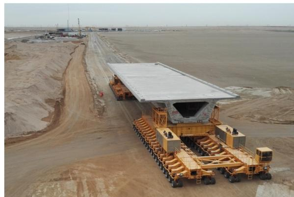
Figura 15. Transporte de vano completo desde planta de prefabricación
