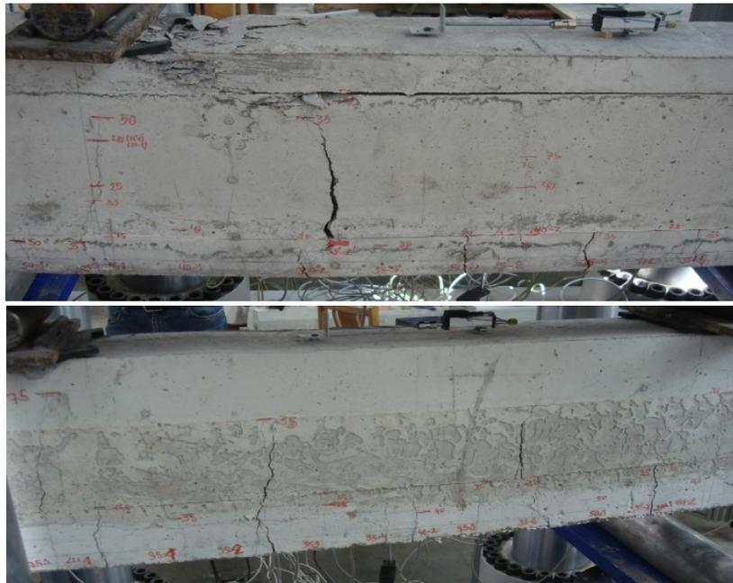
Figura 7. Patrón de fisuración en vigas MC1(sup) y MC2(inf)
