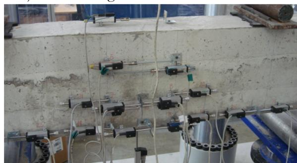
Figura 2. Disposición de extensómetros en viga
