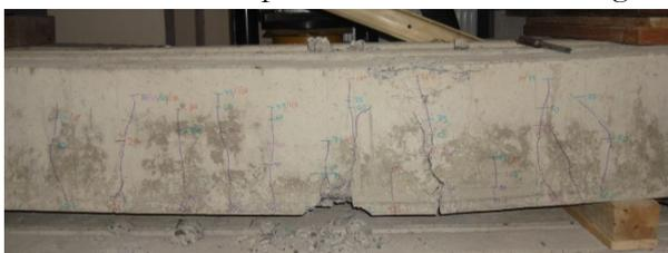
Figura 6. Patrón de fisuras en viga SFRC
